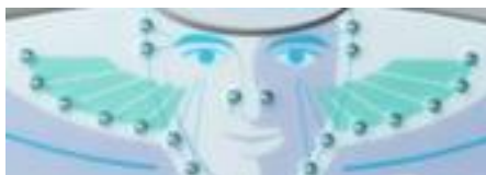
20 Statusanzeigen des horizontalen und vertikalen Sichtfelds
